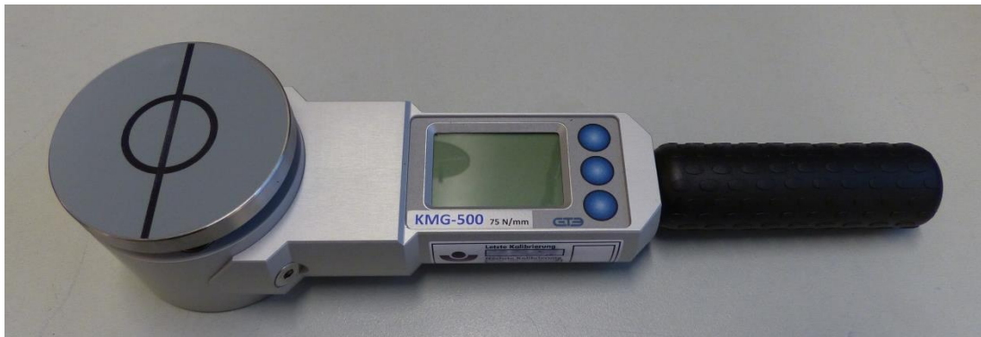
Abbildung 5: KMG-500 mit fest verbauter Feder (75 N/mm)
