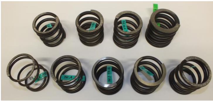
Abbildung 8: Satz mit neun Federn von 10N/mm (Bauch) bis 150N/mm (Kopf/Stirn) für KDMG-300
